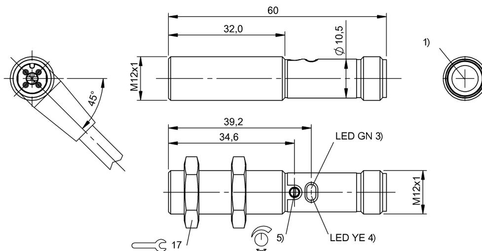
1) 光学轴, 接收器, 3) 工作电压, 4) 光线接收/极限区域, 5) Sn
